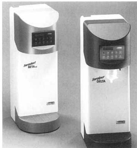
wasser eignet sich somit auch für biotechnologische oder mikrobiologische Prozesse. Als Systemergänzung steht das neue Seradest BETA 60 für die Speisewasservorbehandlung zur Verfügung. Auf der Basis der Revers-Osmose separieren zwei Dünnpfilm-Komposit-Wickelmembranen organische Substanzen, Partikel und Mikroorganismen bis zu 99 %.
