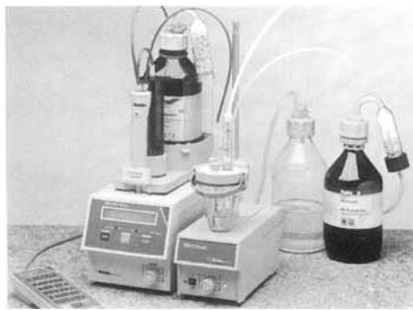
ermöglicht biampferometrische oder bivoltammetrische Titrationen ohne Verwendung von Zusatzausrüstungen. Der KFS-Titrino 720 misst auch den pH-Wert, Spannungen (mV), die Temperatur,  $I_{pol}$  und  $U_{pol}$ . Ein kombinierter Methoden- und Silospeicher erlaubt die Arbeit mit Probenwechslern. Bei umfangreichen Meßserien lassen sich mit einem
